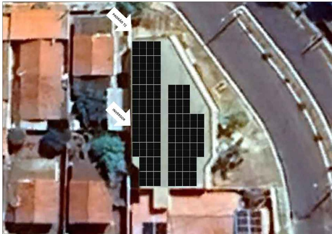
PROJETO SOLAR – LAYOUT DOS MÓDULOS E ESQUEMA DE LIGAÇÃO
