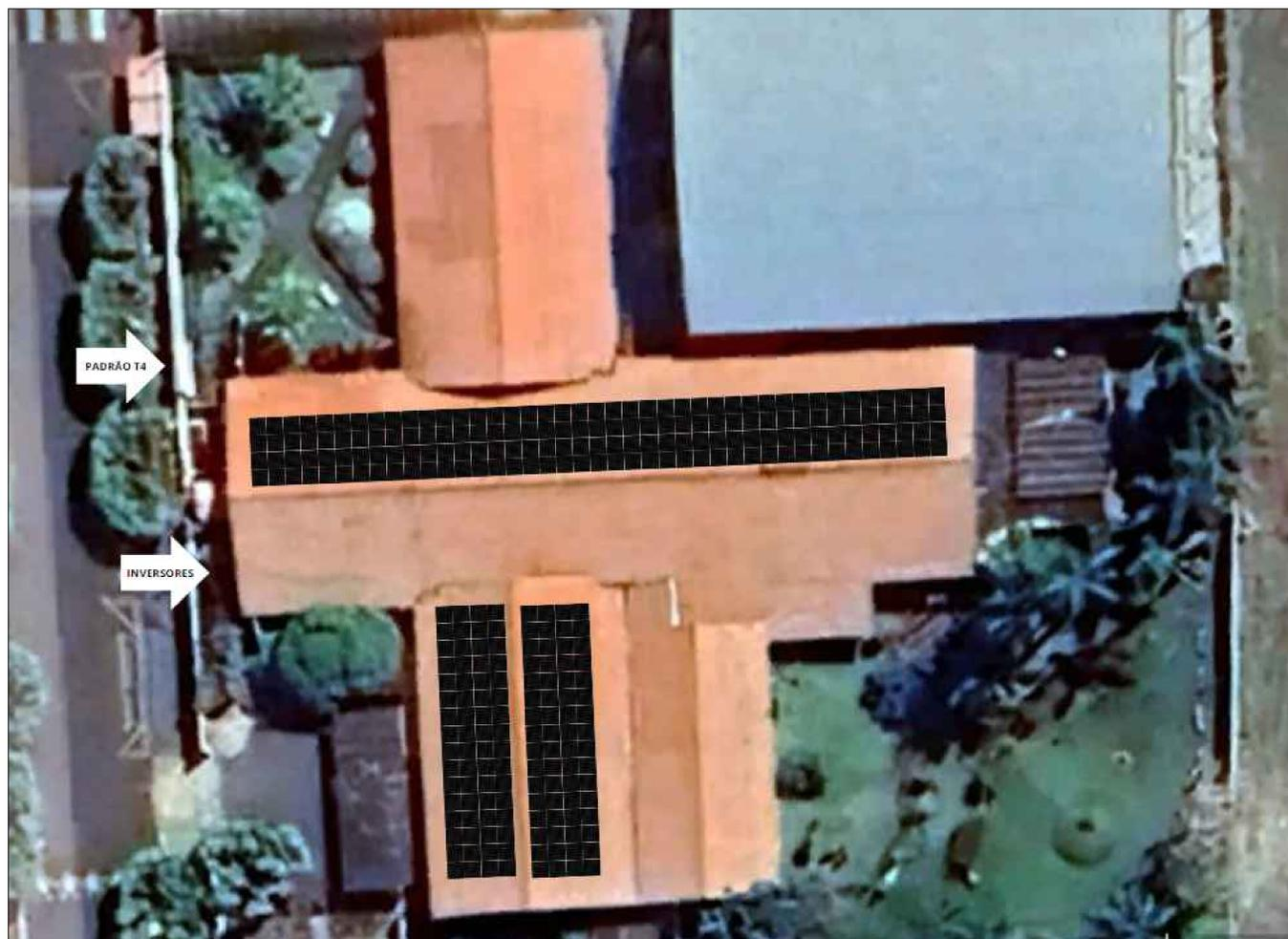
PROJETO SOLAR – LAYOUT DOS MÓDULOS E ESQUEMA DE LIGAÇÃO **FOLHA:** Única
